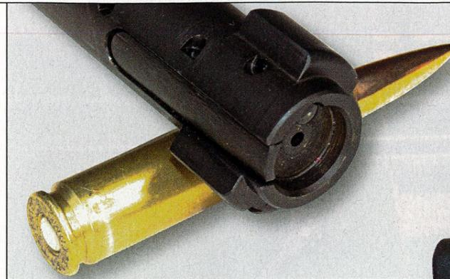
La tête de culasse dispose de 2 forts tenons de verrouillage. Un avantage majeur : la présence d'un large extracteur sous tension, proche du système Sako.
