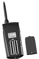
Sustitución de las pilas en el mando CANICOM 1500 Fig. 10
