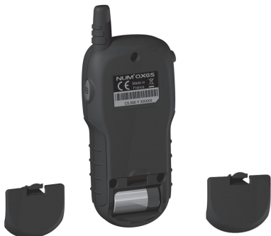
Abb. 7 - Auswechseln der Batterie in das Handsender
