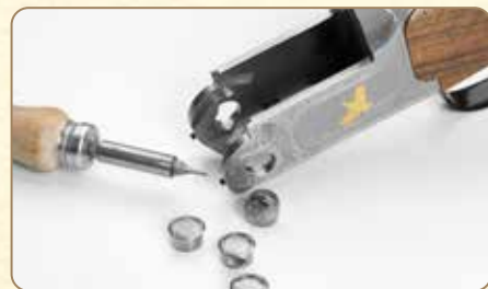
Tourillons bombés interchangeables en acier.
