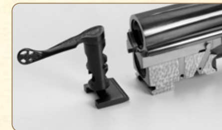
Grand verrou unique (30, 50 mm pour cal.12) avec double crochets de fermeture.
