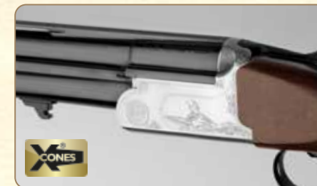
X-CONES® Cônes de raccordement doux et allongés pour réduire le recul même avec ames étroites "18,4 calibre 12". Ames étroites pour augmenter la vitesse et la pénétration des billes.
